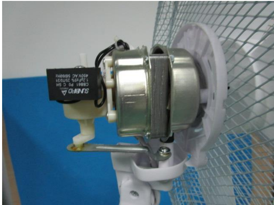
Fan motor and motor capacitor
