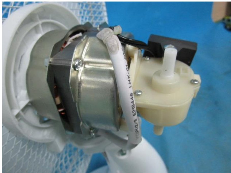
Fan motor view
