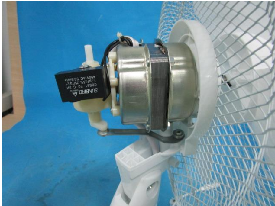
Fan motor view
