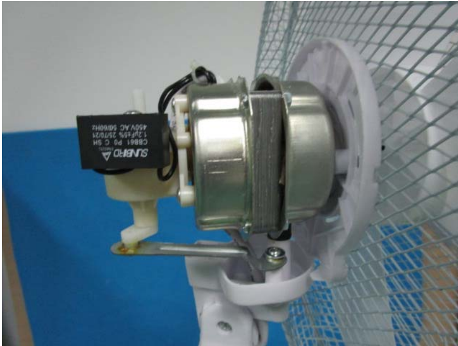
Fan motor and motor capacitor
