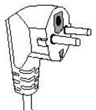
يجب توصيل هذا الجهاز بأخذ مؤرض. هذا الجهاز مجهز بأخذ كهربائي مؤرض. يجب توصيله بأخذ حائط مثبت بشكل صحيح بأخذ تاريخ ملاحظات: إذا كان لديك أي أسئلة بخصوص التأريض أو التوصيل الكهربائي ، يرجى استشارة **الموظفين المؤهلين**. في حالة حدوث ماس كهربائي ، يقلل التأريض من خطر حدوث صدمة كهربائية من خلال السماح بتصريف التيار عبر السلك الأرضي
