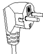
En cas de court-circuit, la mise à la terre réduit le risque de choc électrique en permettant au courant d'être évacué par le fil de terre.
