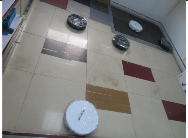
164. Endurance test (discharging)
