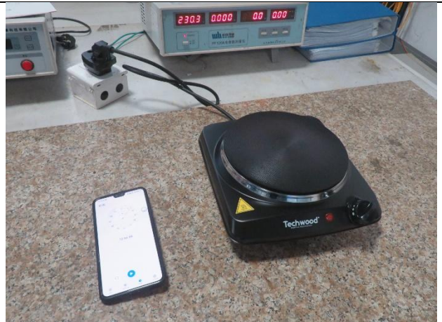
108. Thermal link function test
