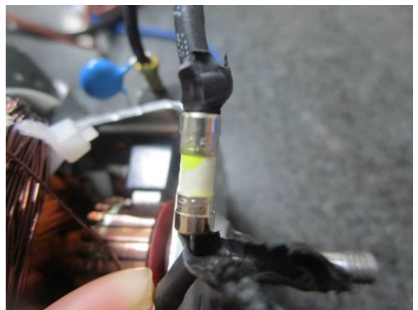
72). Fuse in motor
