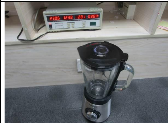
77). Input power check for 2 setting
