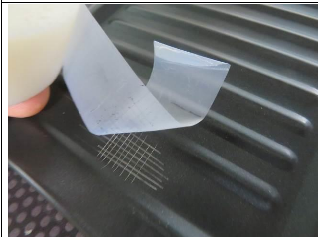
87) Coating adhesion check
