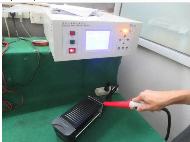
78) Hi-pot check & Earth continuity check
