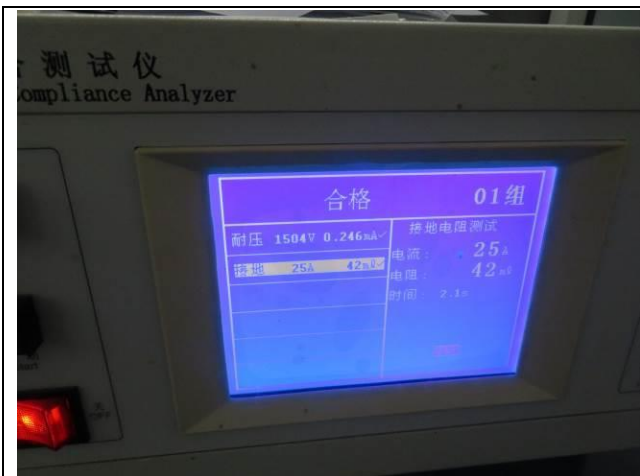
79) Hi-pot check & Earth continuity check
