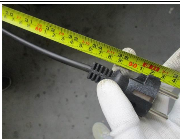
58). Cable length check
